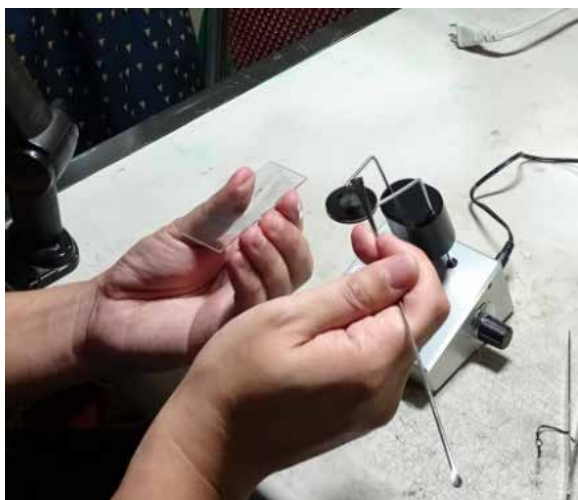
粉末試料充填装置(超音波振動によってキャピラリに微粉末を詰める)とスバチュラで試料を詰めている様子
