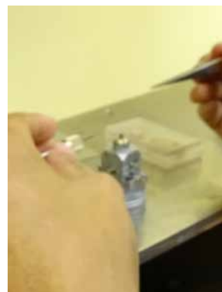
サンプルホルダー (ゴニオヘッド)への キャピラリの装着
